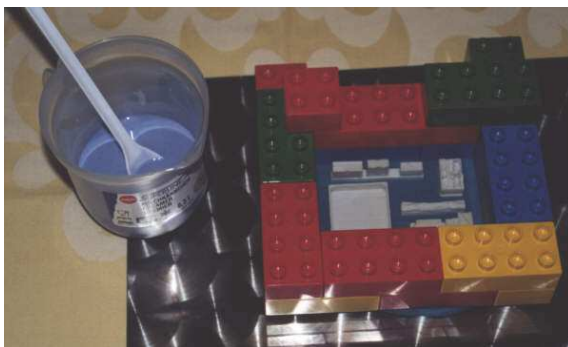
Anordnung der Urmodelle für die künftige Form
