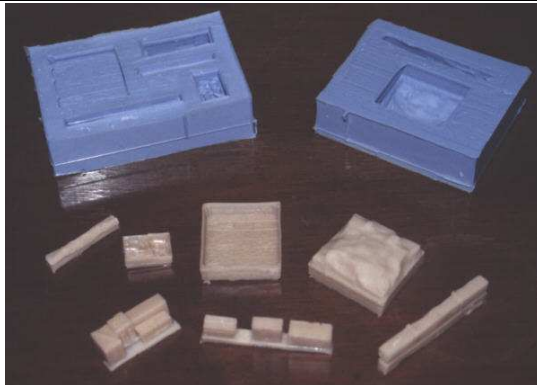
Einteilige Formen mit den selbst gegossenen Teilen
